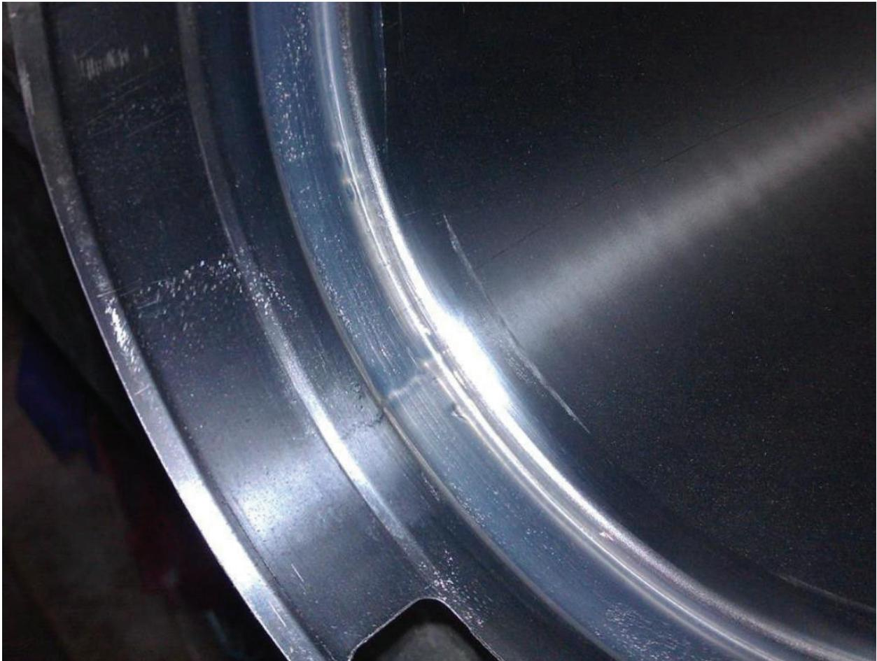
3. Inserte la nueva junta con las aletas orientadas en la dirección correcta.
