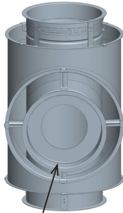
Barrage de graisse position #2
