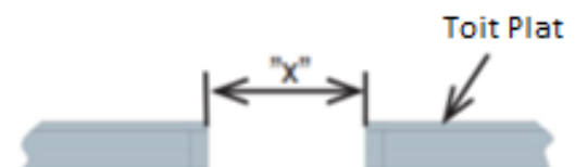
Figure 50 - Ouverture minimale pour toit plat
