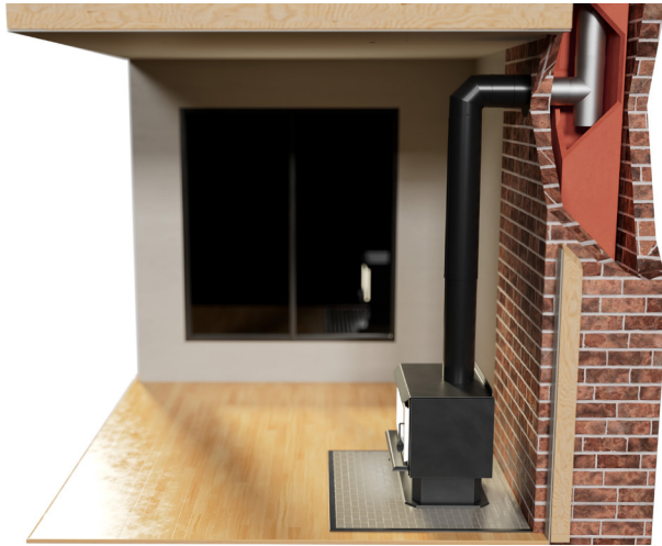
INSTALLATION AVEC CHEMINÉE DE MAÇONNERIE
