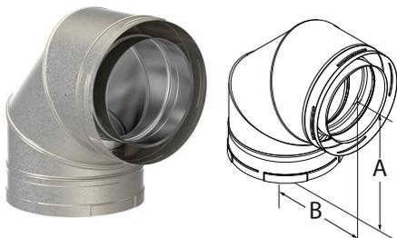
Utilisez lorsque une déviation est requise. Entièrement unitisé, construction à verrouillage rotatif. Avec une base pivotante, ce qui permet au verrou de demeurer complètement engagé lors de l'alignement dans la direction désirée. L'angle est donc maintenu à 90°.
