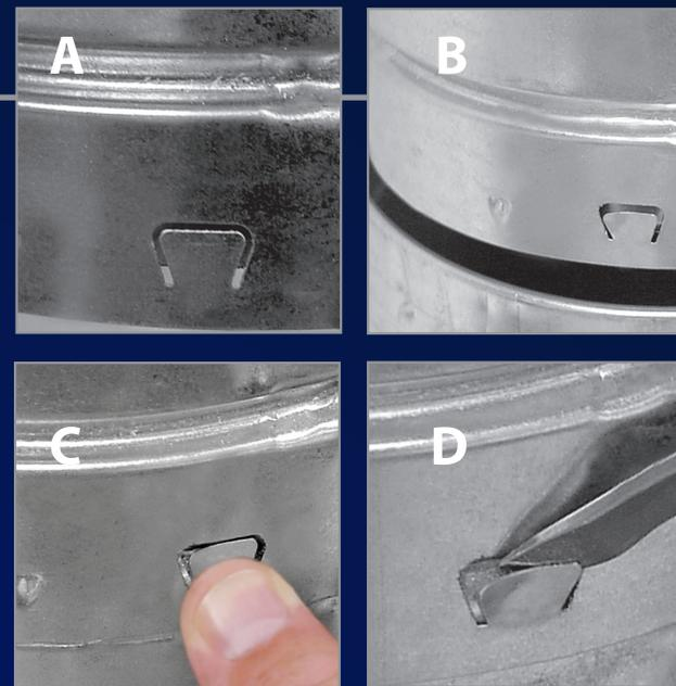
*S'emboîte avec un seul coup, ce qui permet de réaliser une application idéale. Pour le démontage, il suffit de tourner le tuyau, aligner les bosses et de le séparer.*
