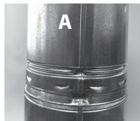
A Aligner le joint vertical des deux tuyaux (assurer que la FLÈCHE sur l'étiquette pointe vers le haut ou en s'éloignant de l'appareil).
